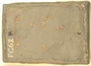
Fotografia do corpo de prova após o ensaio em autoclave
