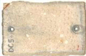
Fotografia do corpo de prova após o ensaio em autoclave
