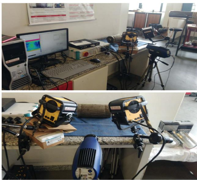
Setup do LNDC para realização dos testes de Termografia
